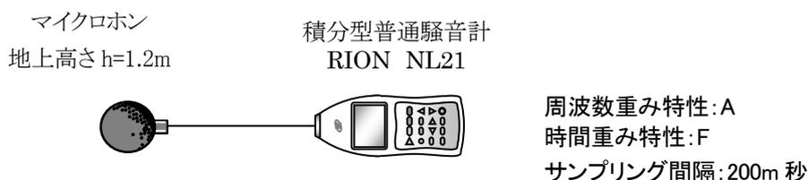
図 2.3 測定機器の構成図(騒音レベル)
